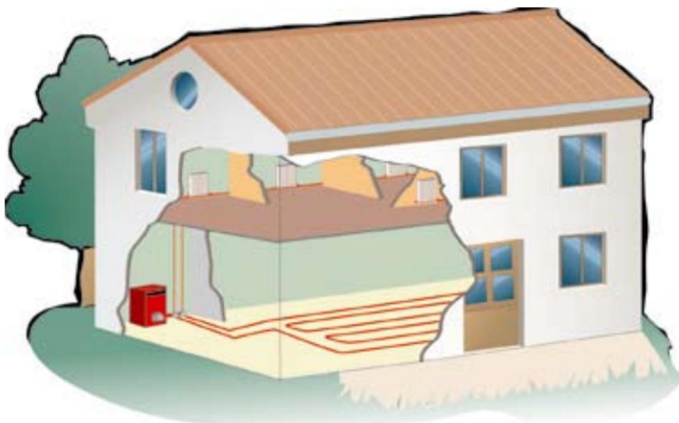
*Une installation de chauffage central à eau chaude comprend une production de chaleur (ici, une chaudière), une distribution (des canalisations) et des émetteurs (ici, un plancher chauffant et des radiateurs).*
